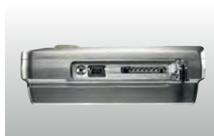
Boční připojení mini-USB kabelu a SD karty
